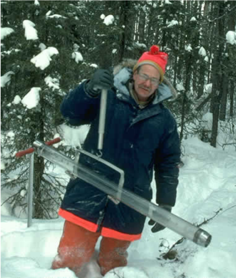
Figure 3 : Photographie d'un scientifique utilisant un découpe-neige. La balance à ressort donne une lecture directe de l'équivalent en eau de la neige en millimètres. L'échantillon est mis en sac et est pesé subséquemment à l'intérieur en raison du vent qui rend la pesée plus difficile.
