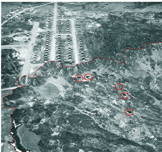
Figure 22 : Glissement de terrain à Saint-Jean-Vianney, Québec. Vue aérienne de la zone de l'escarpement à la tête du glissement de 1971. L'escarpement est indiqué par une ligne tiretée. Quelques maisons déplacées (encerclées) sont visibles parmi les débris sous l'escarpement. Les maisons qui ont été épargnées par le glissement ont été évacuées de façon permanente.
