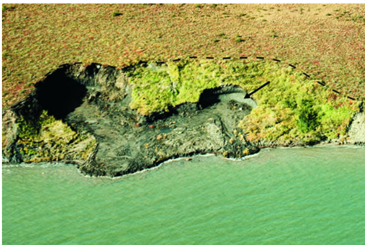
Figure 16 : Glissement régressif dû au dégel dans des sédiments riches en glace, à proximité de Tuktoyaktuk, dans les Territoires du Nord-Ouest. Le glissement fait suite à une réactivation dans une ancienne cicatrice de décollement d'un glissement régressif dû au dégel (une ligne tiretée indique l'ancien escarpement). Le changement de couleur visible dans le couvert végétal reflète une humidité accrue dans l'ancienne niche. De la glace massive souterraine (flèche) est visible dans le nouvel escarpement.
