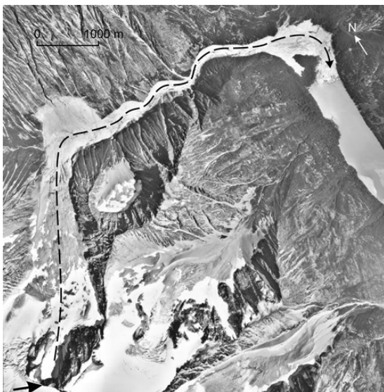
Figure 5 : Avalanche de pierres rapide. Photographie aérienne (1965) montrant la trajectoire (ligne tiretée) d'une avalanche de pierres très rapide survenue en 1959 au ruisseau Pandemonium, en Colombie-Britannique. Des débris rocheux ont dévalé une pente abrupte depuis le point indiqué par une flèche dans le coin inférieur gauche, pour ensuite se déplacer sur près de 8 kilomètres le long de la vallée faiblement inclinée (6 à 9 degrés) d'un cours d'eau, jusque dans un lac visible dans le coin supérieur droit. Il semble que la vitesse de déplacement des débris ait atteint 100 mètres à la seconde.
