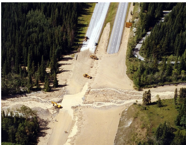
Figure 18 : Coulée de débris au ruisseau Five Mile, Alberta. Une coulée de débris a bloqué la route Transcanadienne pendant 24 heures en août 1999. Cette coulée inattendue a été provoquée par des pluies diluviennes.
