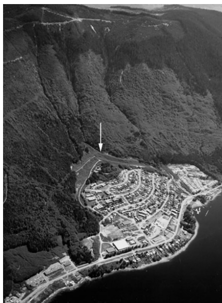
Figure 24 : Dignes de déviation des débris. Des digues de déviation des débris (flèche), érigés en 1976, protègent le village de Port Alice, sur l'île de Vancouver, contre les coulées de débris.
