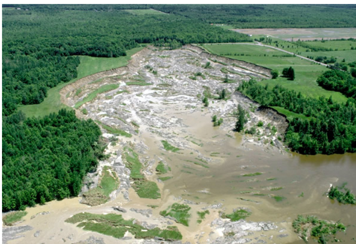
Figure 23 : Glissement de Lemieux, Ontario. Vue aérienne prise quatre jours après le glissement de Lemieux survenu en 1993. Les eaux de crue de la rivière Nation Sud, qui se sont élevées de 12 mètres au-dessus du barrage de débris, ont inondé l'embouchure de la niche de décollement du glissement.
