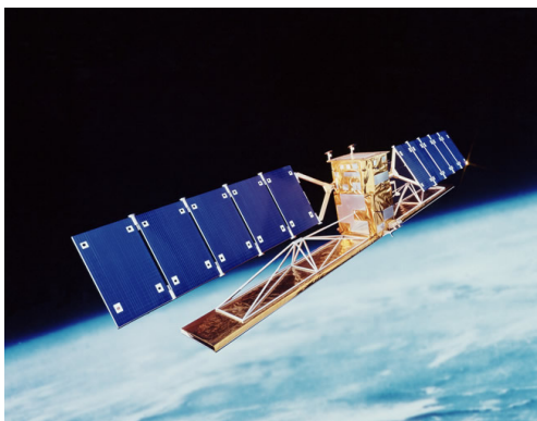
Figure 2 : Satellite canadien Radarsat : le capteur principal pour l'observation des glaces est le radar à synthèse d'ouverture (SAR).
